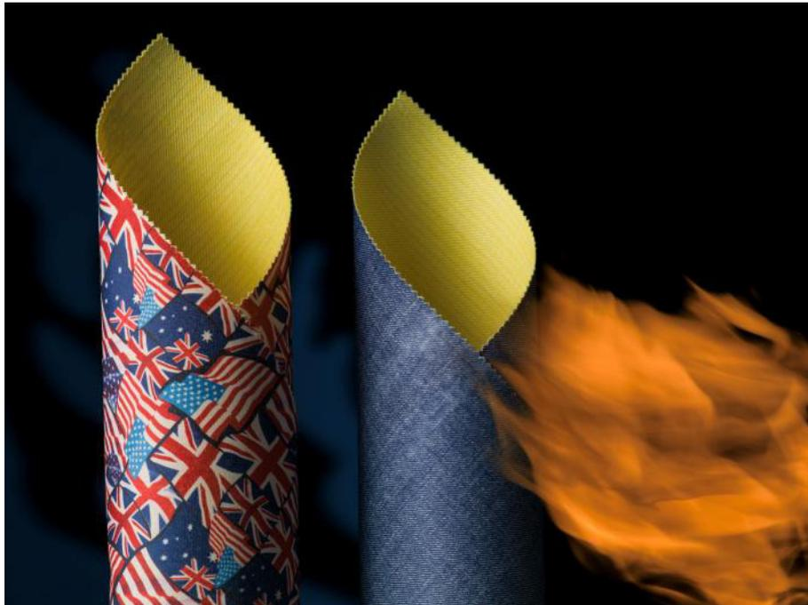
Eröffnet neue Gestaltungsmöglichkeiten: Im Transferdruckverfahren setzt Trans-Textil erstmals hochfarbige Designs auf schwerentflammbaren Geweben um.
